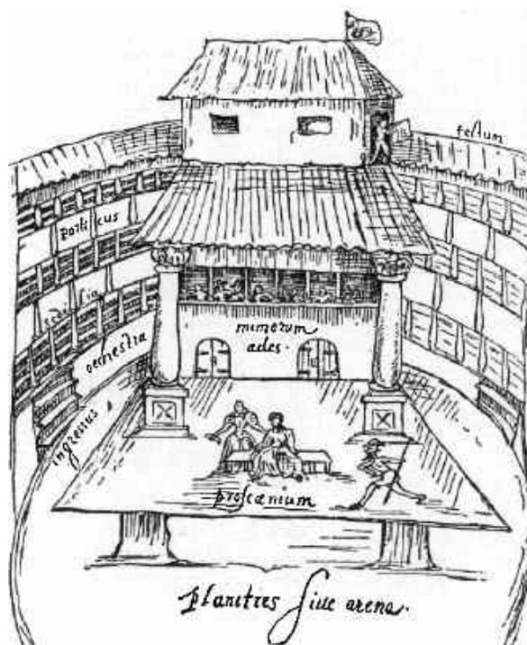
Fig. 1 – The Swan - O desenho de Jan de Witt (1596) demonstra a estrutura cilíndrica que acomodava três galerias de espectadores, sendo a mais alta, protegida por um telhado inclinado para dentro.
